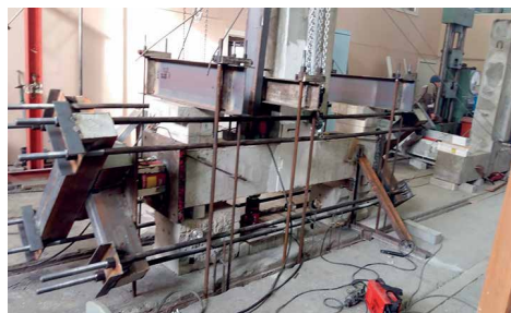
Система РКД. Испытания узла «колонна-ригель»
